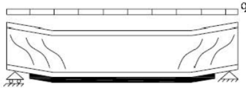
Рисунок 6.4. Потеря местной устойчивости стенки в приопорных зонах балки
